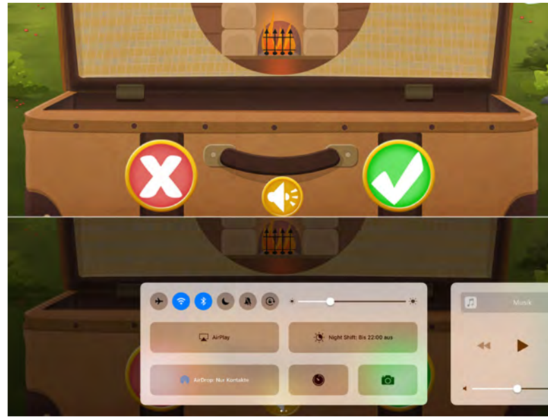
Abb. 3: Wird der untere Bildschirmrand eines Touch-Devices mit interaktiven Elementen belegt, besteht die Gefahr, dass die Systemsteuerung des Geräts versehentlich geöffnet wird.
